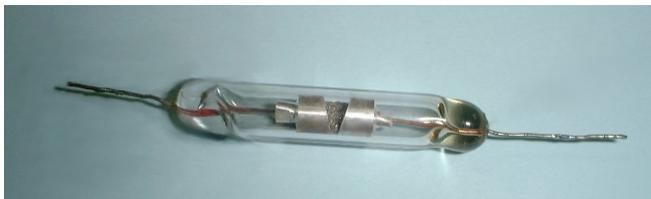
Disons simplement qu'il s'agit d'un tube de verre contenant de la limaille métallique entre deux électrodes.
