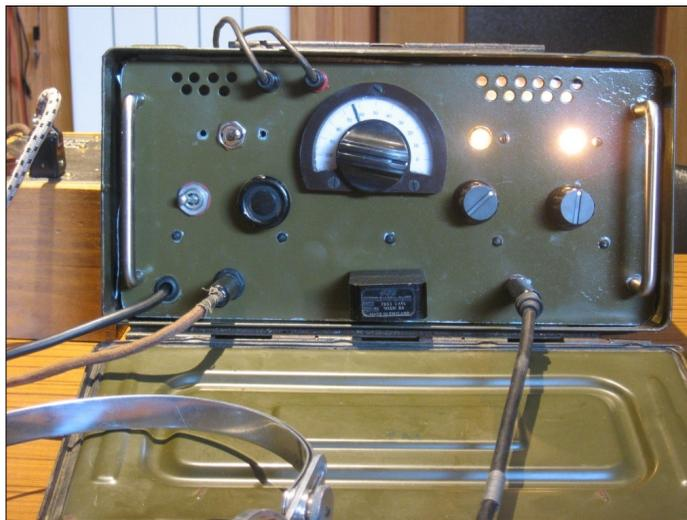
Je dévisse l'ampoule qui ne s'allume plus et le poste passe en émission normale ! Après vérification l'ampoule qui est normalement prévue pour 6 Volts (ampoule dite « de cadran ») était fabriquée pour 3,5V. Le filament survolté a brûlé, c'est normal, mais pourquoi l'émission a-t-elle cessé ? Je n'ai pas d'explication évidente et je recherche dans mon tas d'ampoules récupérées une qui
