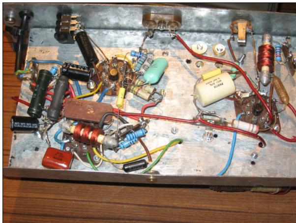
Enfin si, il y en a un de taille : je n'entends rien dans le casque, même pas le ronronnement des tubes et quant à l'émission : nenni quelle que soit la position des CV d'accord. Pas la moindre lueur sur les lampes témoin, aucune vibration annonciatrice, nada. Pourtant les tubes chauffent normalement.
