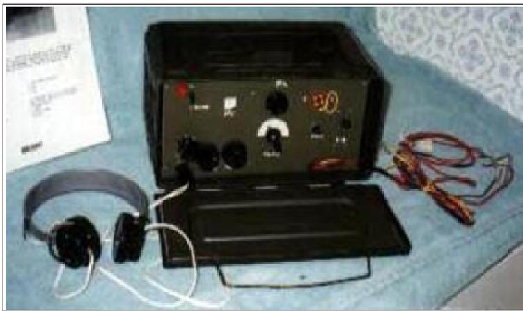
La façade de l'un des deux (grande charnière) ressemble énormément à celle d'un PARASET et utilise en particulier le même moyen d'accord : l'éclairage simultané de deux lampes de cadran. Les commandes sont exactement
