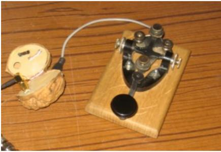
Grâce à un ami j'ai découvert un schéma de mini-poste de radio, émetteur et récepteur à conversion directe, le PITITICO. Après l'avoir réalisé (pas difficile, un seul transistor 2N2222 et pas de circuit imprimé) je me suis aperçu qu'il ne fonctionnait pas vraiment en réception « réelle », même si en attaquant l'entrée antenne avec un générateur HF bien costaud on entend le signal. Mais je n'arrive pas à entendre mes amis à 8km de la maison, même
