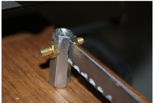
Les contacts droite et gauche sont espacés de 1.5 cm de l'axe de fixation de la lame de scie.
