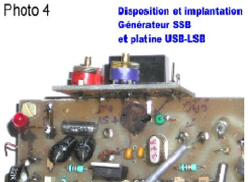
L'ancien CV ajustable de la version BINGO mono-bande est supprimé et le point chaud du CV est relié par un STRAP en fil de 5/10 ème à la platine de commutation LSB-USB, disposée verticalement et soudée sur le circuit imprimé de base.
