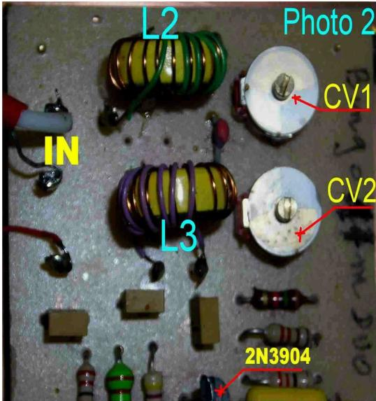
L'étage amplificateur Driver se compose d'un double filtre de bande ( L2, L3) accordé sur 17 m et d'un amplificateur large bande composé de 2 transistors en cascade : un 2N2222 et un 2N2219.
