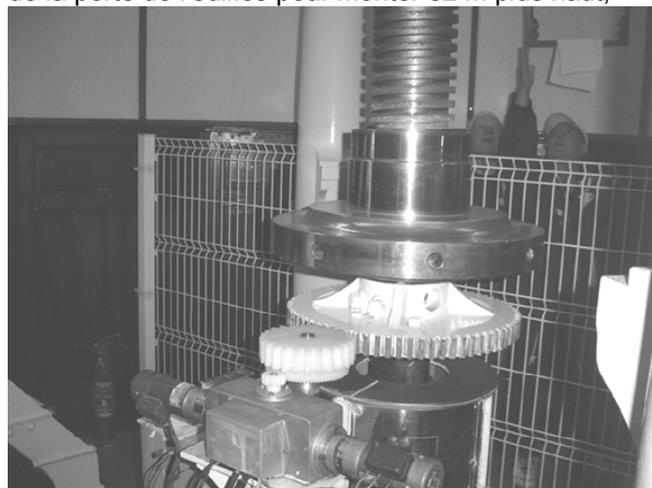
malgré la bruine du moment ! Belle ascension tranquille, toujours une aussi belle mécanique signée BBT, mise à jour électriquement avec un petit moteur 24 Volts qui remplace les contrepoids d'horlogerie ! Mais le mécanisme d'engrenages est différent des autres déjà vus, est-ce pour un choix de rythme ???
